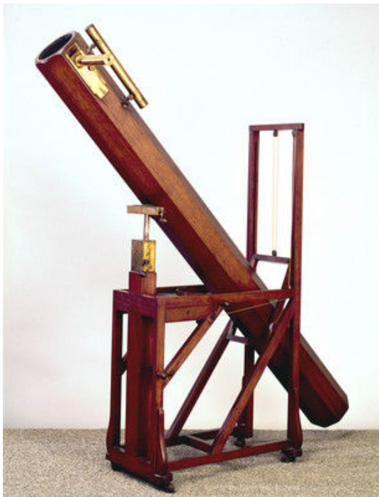
Mynd 9. Newtonssjónauki, sem William Herschel smíðaði uppúr 1783. Hann líkist mjög sjónaukanum, sem Úranus fannst með árið 1781, og talinn var besti sjónauki þess tíma. Þvermál holspegilsins var um 16 cm og lengd sjónaukans 2,1 m. Ljósmyndin er frá Science Museum í London.
