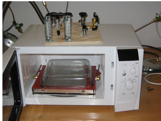
Mynd 1. Rafgasklefinn í örbylgjuofninum. Ofan á ofninum eru þrýstingsmælur og ventlar til að stjórna gasflæði um klefann.
