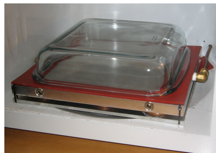
Mynd 6. Séð inn í rafgasörbylgjuofninn. Á milli tveggja álplatna liggur koparrör til kælingar. Þar ofaná er gúmmiþétting og glerkúpull (eldfast mót).
