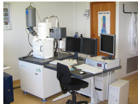
Mynd 4. Rafeindasmásjá af gerðinni LEO sem staðsett er á Iðntækni-stofnun með sambyggðri Raith rafeindalitógráfi. Rafeindalitógráfihlutinn er í grófum dráttum fullkomnari stýring á rafeindageislanum en fylgir með smásjánni sjálfri.
