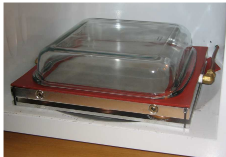
Mynd 6. Séð inn í rafgasörbylgjuofninn. Á milli tveggja álplatna liggur koparrör til kælingar. Þar ofaná er gúmmíþétting og glerkúpull (eldfast mót).
