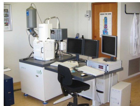
Mynd 4. Rafeindasmásjá af gerðinni LEO sem staðsett er á löntæknistofnun með sambyggðri Raith rafeindalitógrafi. Rafeindalitógráflutinn er í grófum dráttum fullkomnari stýring á rafeindageislanum en fylgir með smásjánni sjálfri.
