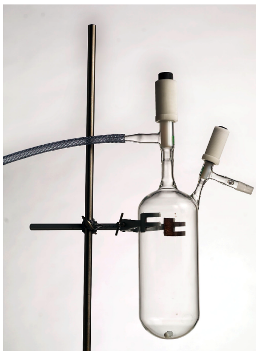
Mynd 4. Hvarfhylki notað til smíði á efni 7.
